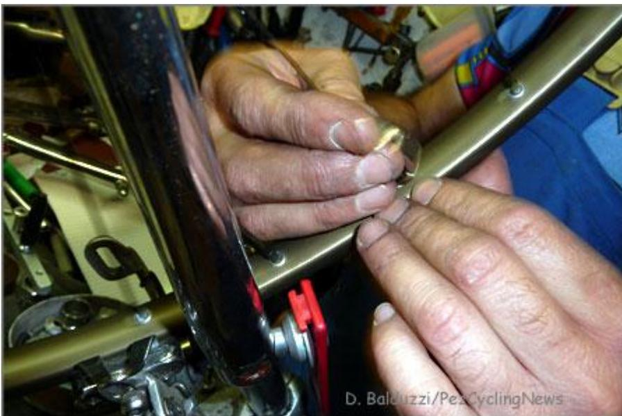
*Un banco per la centratura? Marco usa una vecchia forcella fissata ad una morsa. Il freno anteriore misura la centratura della ruota, mentre un leva gomme rosso sul retro ne determina la rotondità.*
