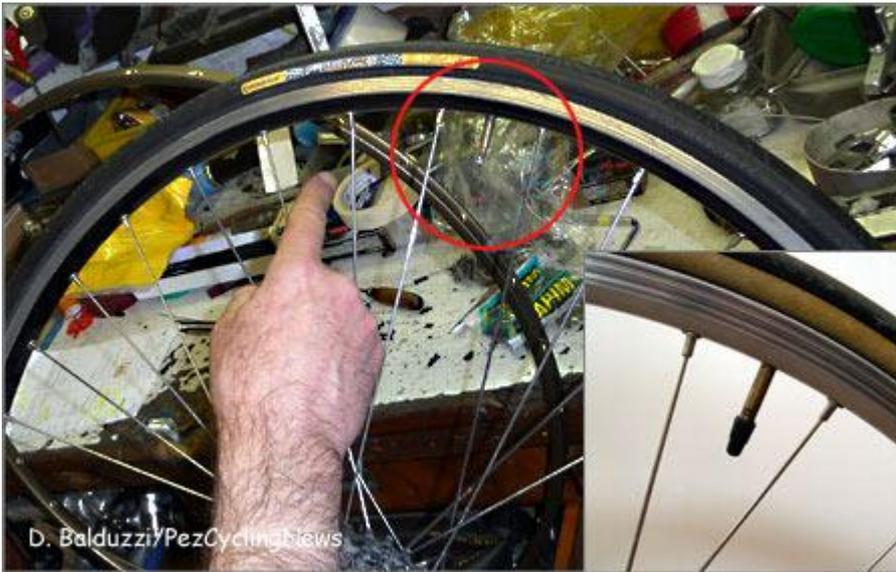
*Il circolo rosso indica la posizione ideale per la valvola – c'è molto spazio per la testa della pompa ed una uguale distanza tra i raggi. Il dito di Marco indica la posizione tipica e il riquadro ne mostra una peggiore. Notate anche il corretto posizionamento dell'etichetta del copertone.*
